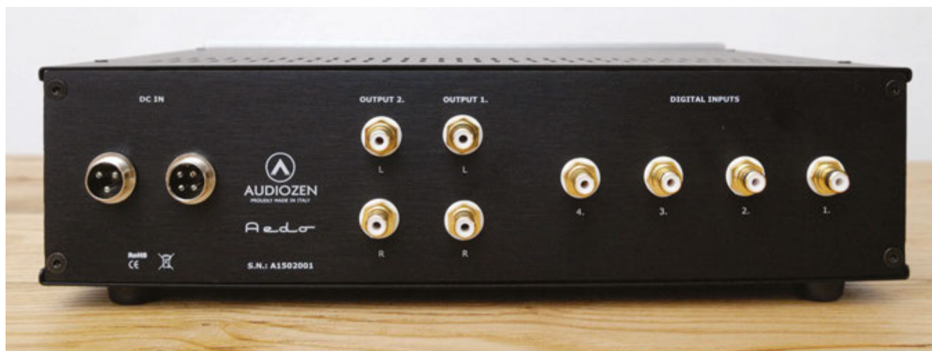
Il telaio dell'alimentatore si connette all'unità principale mediante i due connettori di sinistra. Gli ingressi digitali selezionabili sono quattro, tutti su coassiale RCA S/PDIF (vista tanta ridondanza, uno di questi lo avrei fatto BNC). Per la felicità degli "ascoltoni" in cuffia, le uscite analogiche sono due: RCA nella dotazione standard, XLR in opzione.
